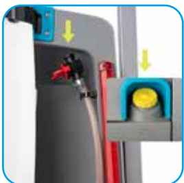
Fyllestasjon Fyll, etterfyll og tøm imop Lite enkelt. Ikke lenger bundet til faste fyllestasjoner, få ferskvann fra i-drive eller tøm oppsamlingstanken i co-botic 65.
