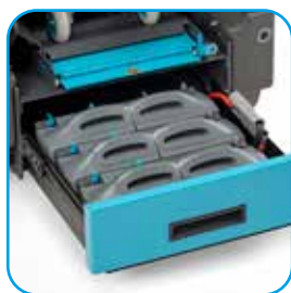
Batteriskuff Batteristativet har plass til seks i-power 14-batterier som gir deg en driftstid på 80 minutter. For å bytte batterier drar du bare ut stativet og skyver ut batteriene. Ved å bytte og lade batterier er 24-timers drift mulig.
